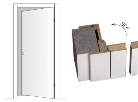
Угол открывания зависит от дверного проема, модели двери, технических характеристик петель и габаритных размеров ручки, и толщины плинтуса: без плинтуса угол открывания составляет 175°; с плинтусом угол открывания - 95°
