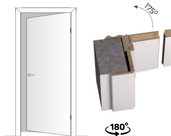
Угол открывания зависит от дверного проема, модели двери, технических характеристик петель и габаритных размеров ручки, и толщины плинтуса. Для петель K2760, плинтуса толщиной 16 мм угол открывания 175°
